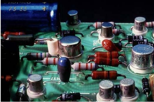
[Nella foto : circuito con transistor] Tra i componenti di questo circuito, i transistor sono riconoscibili dalle capsule cilindriche argentate che li ricoprono. Ognuno di essi consiste di un pezzetto di silicio che, "drogato" da un certo numero e tipo di atomi, si comporta come un semiconduttore di tipo n o di tipo p. Inventati nel 1948, i transistor sono componenti fondamentali dei moderni circuiti, in cui possono entrare come amplificatori, interruttori o oscillatori.
